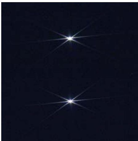
Abbildung 4.31 Beugungsbild der Bahtinov-Maske: oben defokussiert, unten fokussiert.
