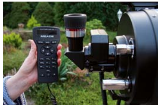
Abbildung 4.32 Motorische Fokussiereinheit des Meade LX200 mit Handbox, die auch für die Navigation verwendet wird.
