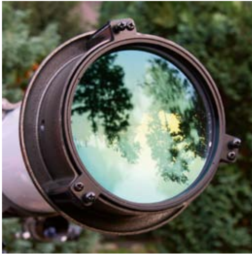
Abbildung 3.20 Achromatisches Linsenobjektiv mit mehrschichtiger Vergütung und Justierschrauben.
