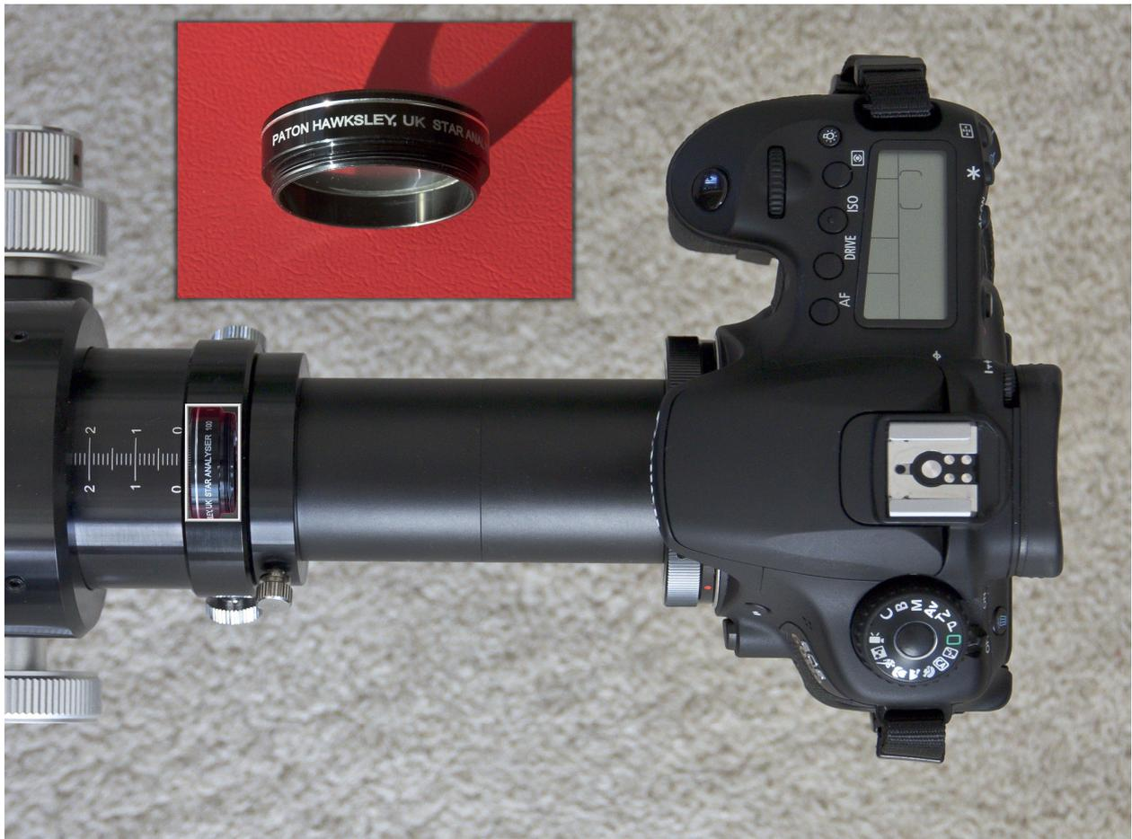
**Abbildung 6:** Instrumenteller Aufbau mit Okularauszug, Verbindungsadapter mit eingesetztem Gitter, Distanzhülse und DSLR-Kamera. Die Position des Gitters ist markiert. Die Projektionsdistanz beträgt 155 mm.
