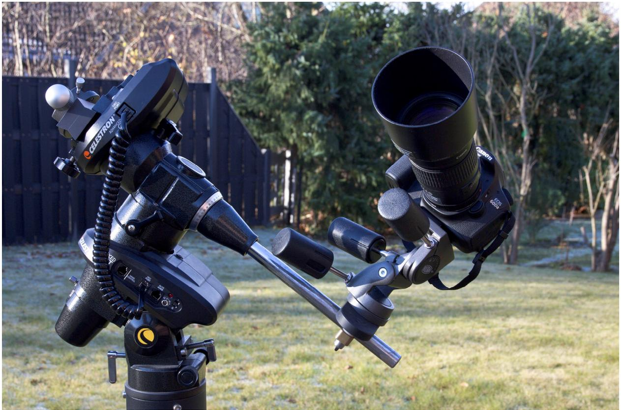
**Abbildung 4:** Canon EOS 60Da auf einem 3D-Neigekopf an der Deklinationsachse einer parallaktischen Montierung mit motorischer Nachführung.
