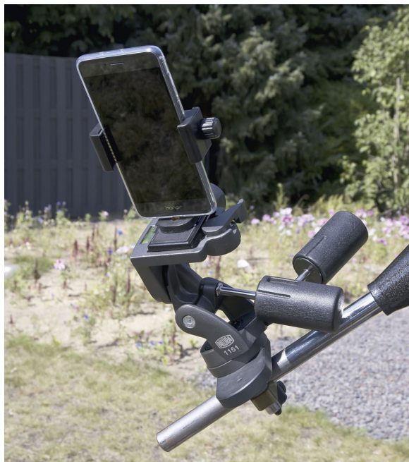
Abbildung 4.98 Smartphone mittels Stativhalterung auf einem 3D-Stativkopf an der Deklinationsachse einer parallaktischen Montierung befestigt.
