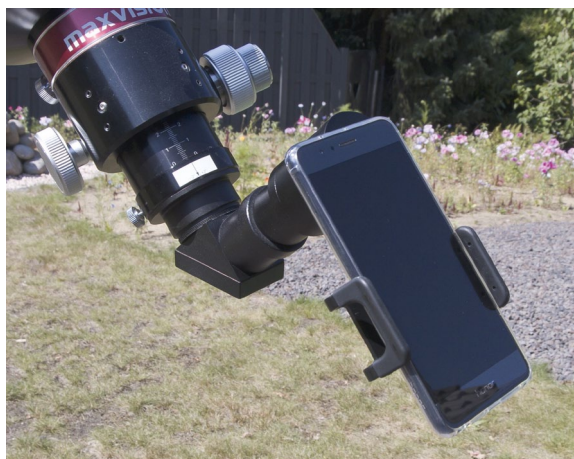
Abbildung 4.99 Montage eines Smartphones bei Verwendung eines Zenitspiegels.
