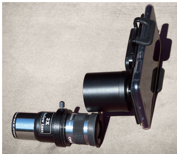
Abbildung 4.100 Komponenten einer Konstruktion (Setup) zur Astrophotographie mit einem Smartphone durch ein Fernrohr.
