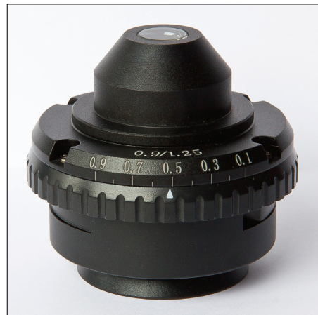
Abbildung 3.4 Kondensor des Motoc BA310E mit direkter Größenangabe der Aperturblende.
